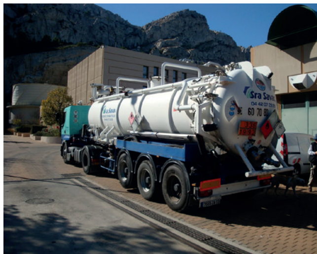
Citerne ADR pour le transport des boues séchées.
