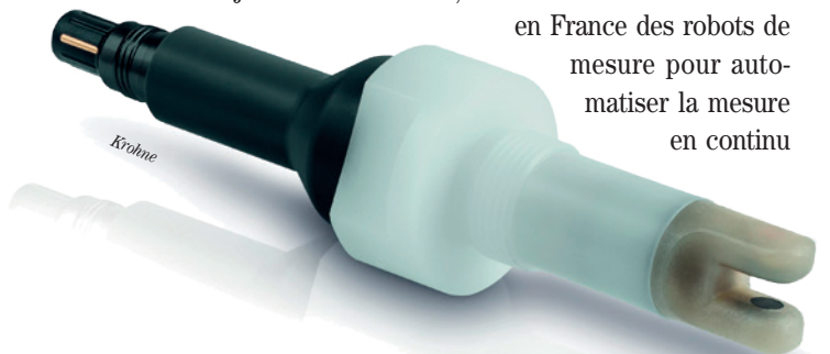
SmartPat Cond 5200 de Krohne (échelle de mesure pour la constante de cellule c=1 : 10 µS/cm'15 mS/cm) est conçue pour l'utilisation sur les process de séparation lors du traitement de l'eau ou des eaux usées dans les industries chimique, pétrochimique et dans l'industrie de l'eau et des eaux usées.
