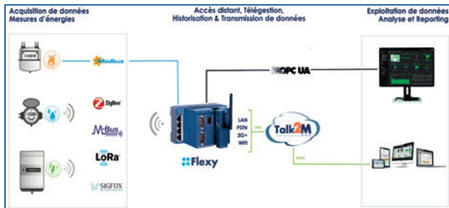
**La passerelle intelligente eWon Flexy offre de nombreux protocoles de communication en local pour les capteurs/compteurs et sur Internet pour pousser ses données, offrant ainsi un système de télégestion unique, puissant et évolutif.**
