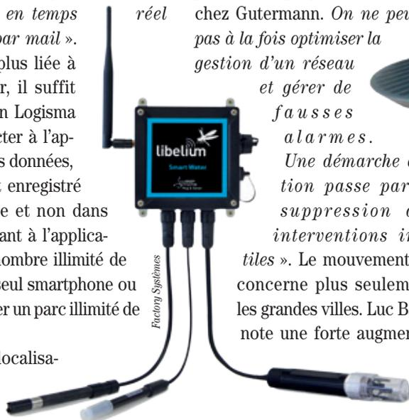
Libelium, la plateforme de capteurs sans fil destinée surveiller la qualité de l'eau à distance, commercialisée par Factory Systèmes, est équipée de plusieurs capteurs ultra basse puissance capables de suivre une dizaine de paramètres.
